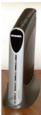
Телефонный модуль HN1040 специально разработан HNS для обеспечения высококачественных телефонных соединений через систему HughesNet. HN1040 подключается по интерфейсу Ethernet 10/100 BaseT к спутниковому модему HN9260/HN9460.
